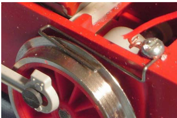
Bild 6. Stark vergrößerte Aufnahme eines Radstromabnehmers.
