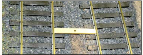
Die Bohrschablone wird einfach zwischen den Gleisen eingelegt und gibt so die genaue Position für das Bohrloch an.
