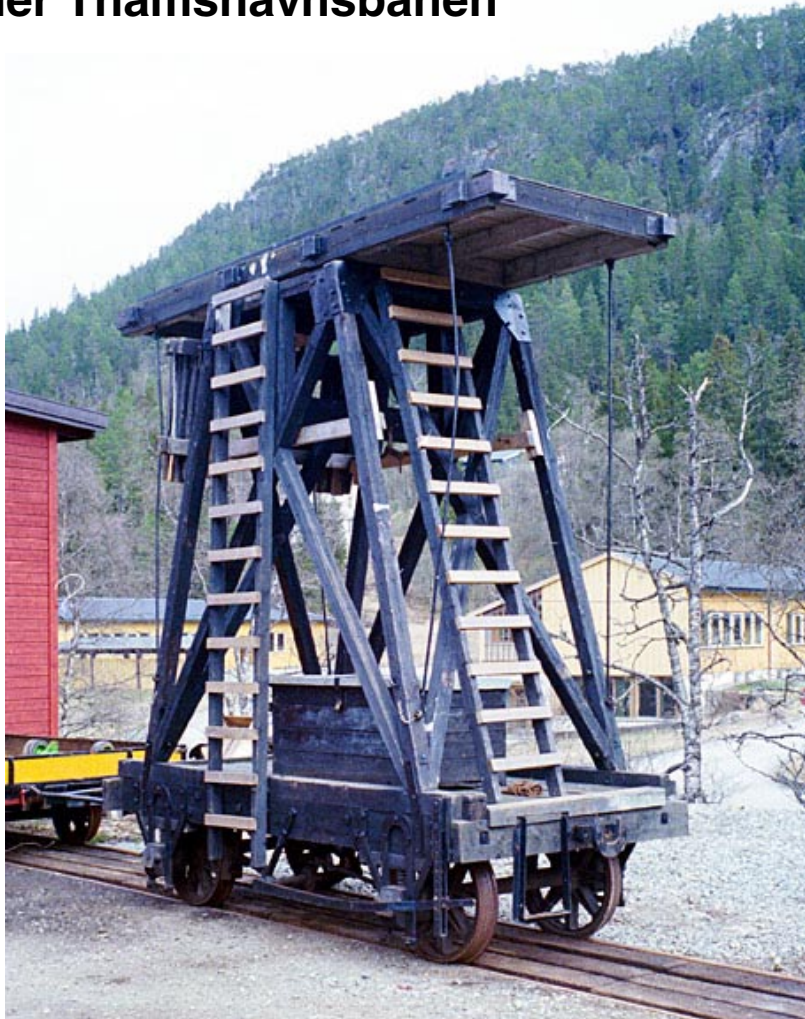
Der Turmwagen aufgenommen im Bahnhof Løkken
